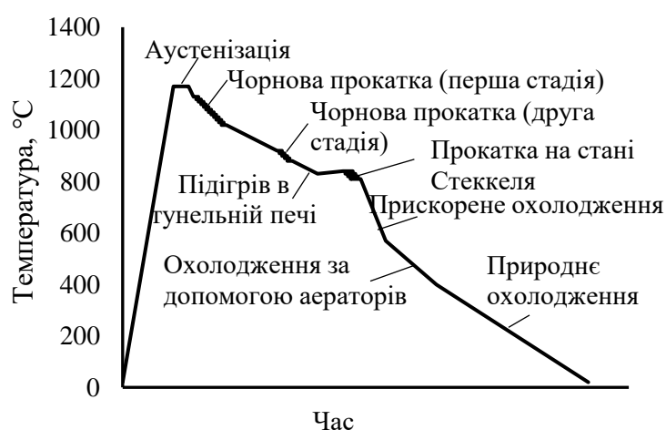
Рис. 15. Схема термомеханічного процесу прокатки сталі категорії міцності X65 на стані Стеккеля
